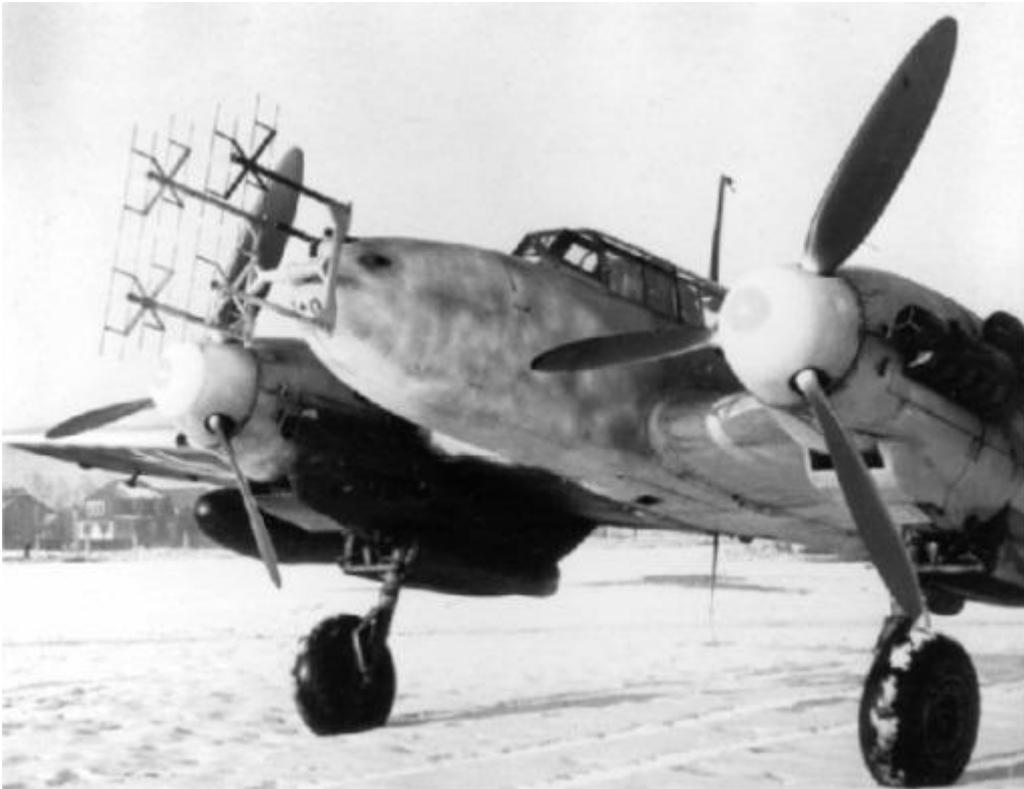
Il Messerschmitt BF 110 caccia notturno equipaggiato del radar Lichtenstein FUG 202 armato di 2 cannoncini da 20 mm e 4 mitragliatrici da 7,8. Altri modelli erano equipaggiati anche con cannoncini da 30 mm. Esisteva inoltre una versione con cannoncini rivolti verso l' alto per attaccare le formazioni di bombardieri dal basso.
